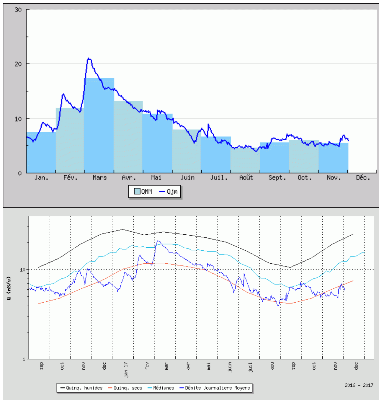
Figure 4 : Hydrologie de la Touvre à Gond Pontouvre Avant et durant la campagne hydrobiologique 2017 (origine des données : SPC VCA Centre de La Rochelle / HYDRO-MEDDE/DE)
